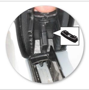
Forsikre deg om at dekslene til fix point sitter vertikalt under putene.
