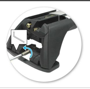
Clamp 470A Kit K353 Clamp 469A • Odręć śrubę zabezpieczającą.
